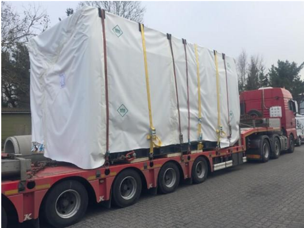
Transport des Liners mit einem Gesamtgewicht von 43 Tonnen
